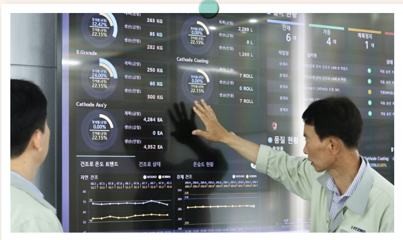
실시간 생산 정보 수집을 위한 MES(Manufacturing Execution System) 시스템
