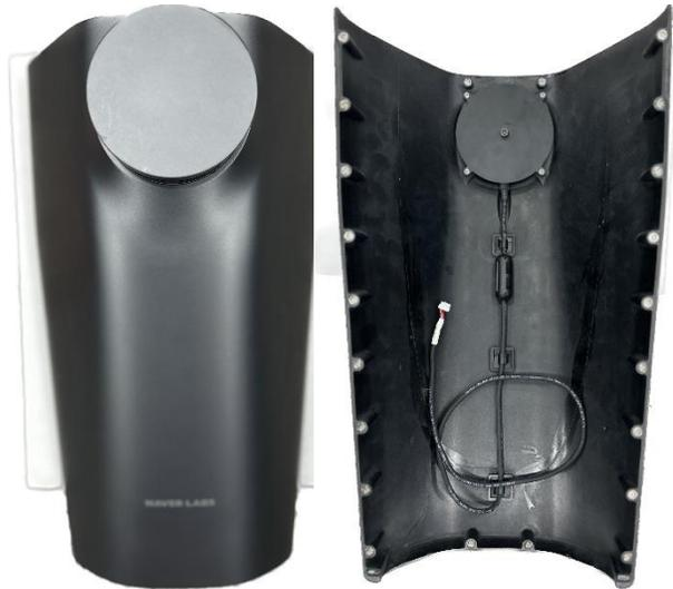
T2B 후면 커버 및 V-LiDAR 케이블
